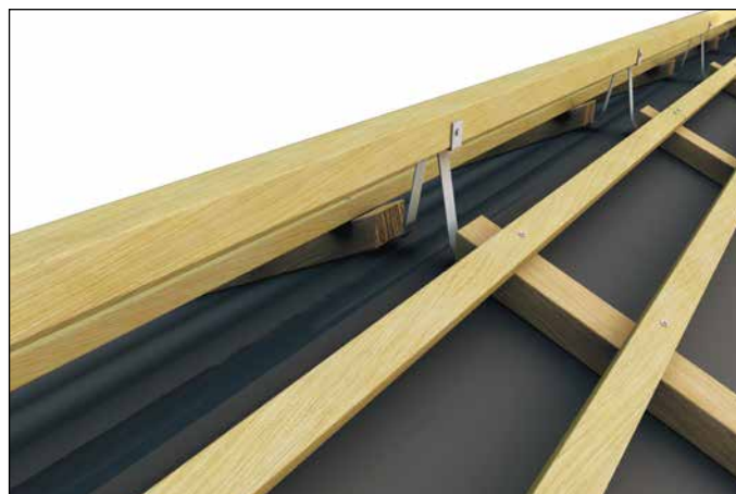
Вариант 1: Коньковый брус — монтаж с коньковыми кронштейнами
