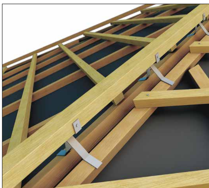
Вариант 1: Вальмовый брус — монтаж с коньковыми кронштейнами
