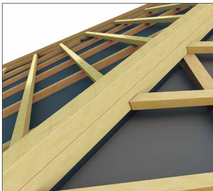
Вариант 2: Вальмовый брус — монтаж с планкой обрешетки
