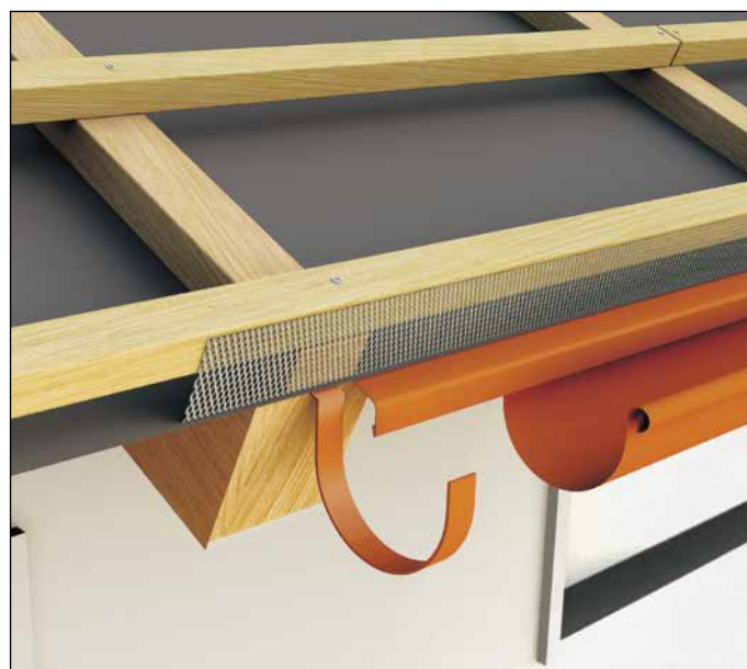
Вариант 2: Капельник заходит в водосток
